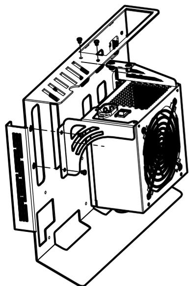
Остальные не нужные провода можно оставить внутри корпуса и закрыть нижней панелью закрепив винтами М4.
