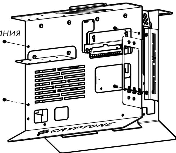
Перед установкой блока питания на корпус, установите материнскую плату, подключите шлейф ГПУ, кнопку включения, разъемы SATA, так как после установки БП к ним доступ может быть ограничен.
