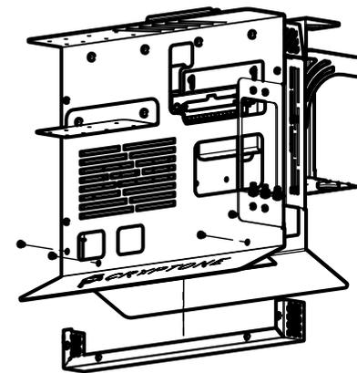
Установите видеокарту, зафиксируйте планками ГПУ-1,2, затяните винтами М4.
